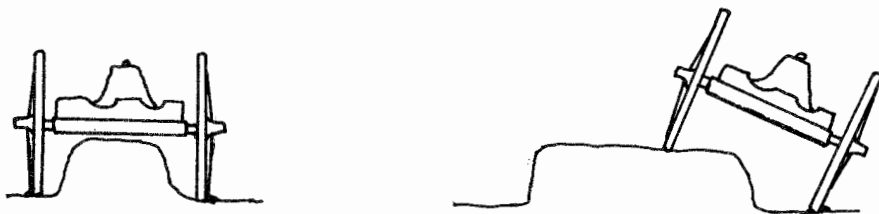
Fig. 7. Position de l'avant-train dans le labour en billons.
